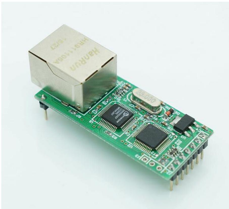
USR-TCP232-T 型号产品为插针式封装，TTL 串口电平，2KV 电磁隔离的 RJ45 接口，小体积的 TCP/IP 串口协议模块。
